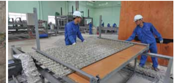
Sản xuất tấm lợp từ nhôm và nhựa tách ra từ vỏ hộp sữa
